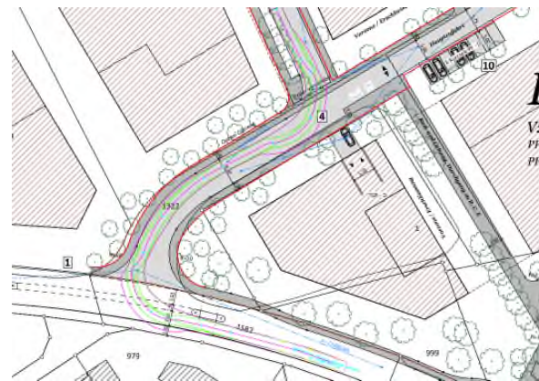
Abbildung 27 Schlepplinienachweis Gelenkbus für Knoten Hauptzufahrt und Knotensituation mit Durchfahrtsbeschränkung. a) Fahrtrichtung Leuggern, b) Fahrtrichtung Döttingen
