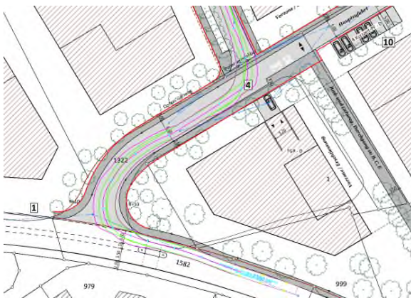
Abbildung 27 Schlepplinienachweis Gelenkbus für Knoten Hauptzufahrt und Knotensituation mit Durchfahrtsbeschränkung. a) Fahrtrichtung Leuggern, b) Fahrtrichtung Döttingen
